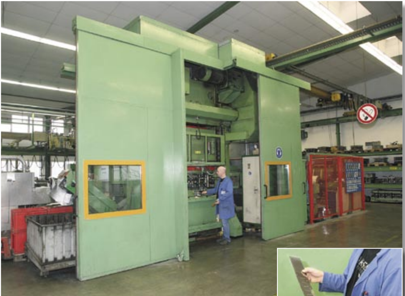
Bild 3: Eine Kaiser- Presse mit 200 Tonnen Druckkraft fertigt die Edelstahlklipse
