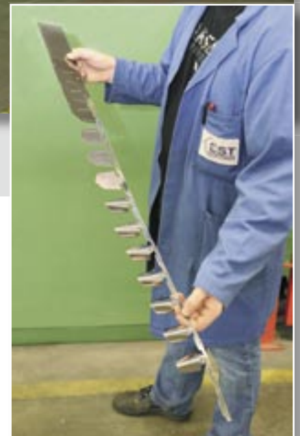
Bild 4: Die einzelnen Arbeitsschritte sind am Coilstreifen sehr gut zu sehen
